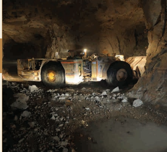
Chargeuse souterraine CAT1700 dans la première chambre de transport à Yalea.
